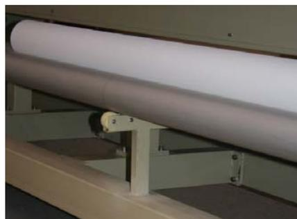
Широкий, выполненный из твердых алюминиевых сплавов печатный стол значительно облегчает конструкцию, позволяет избежать вибраций, гарантирует точность, надежность и долговечность эксплуатации системы.
