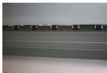
Печатающие головки, установленные в шахматном порядке, благодаря этому повышается производительность работы принтера и уменьшается эффект "матраса". Рамная конструкция каретки имеет дополнительную глубину посадки печатающих головок, что защищает их от возможных механических повреждений. Каретка, выполненная из твердых алюминиевых сплавов, что делает ее легкой и надежной.
